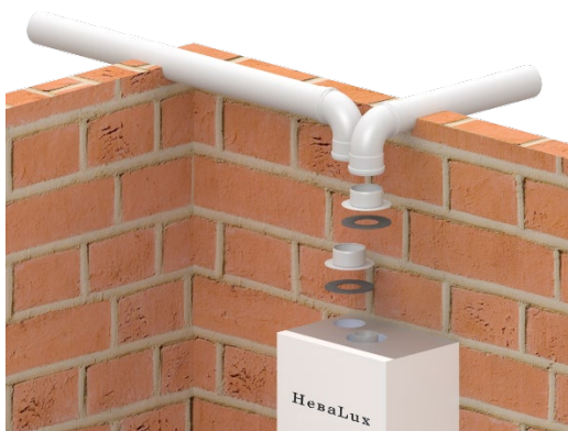
Рис. 4 Схемы присоединения раздельного дымохода \varnothing 80 мм к котлу
