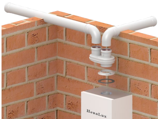
Рис. 4 Схемы присоединения раздельного дымохода \varnothing 80 мм к котлу
